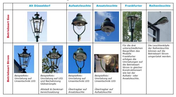
d) Sofern keine strombetriebenen Umbauten der Gasleuchtenmodelle eingesetzt werden können, werden technisch-dekorative oder technische LED-Leuchten zur Straßenbeleuchtung verwendet (s.a. c) 1. Leitlinien allgemein).
